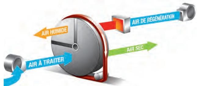
Le système DIA utilise deux flux d'air indépendants et à contre-courants traversant la roue déshydratante à rotation lente et continue :
